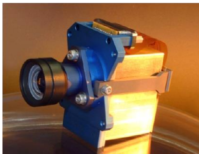
Eine von sieben hochauflösenden Miniaturkameras für das CIVA-Instrument des Kometenlanders Philae ©CSEM
