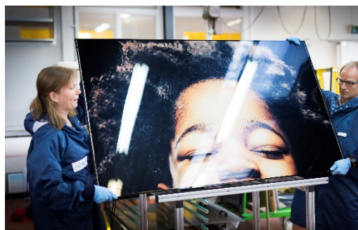
Cette photographie est en fait un panneau solaire et montre jusqu'où les possibilités esthétiques peuvent aller aujourd'hui. (Photographie réalisée par le CSEM, acteur technologique du projet Be-Smart, et développée sur la base de sa technologie KALEO).
