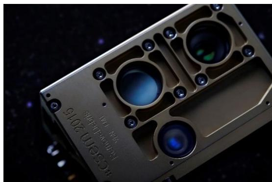
Von CSEM entwickeltes sichtbasiertes Navigationssystem (VBN)
