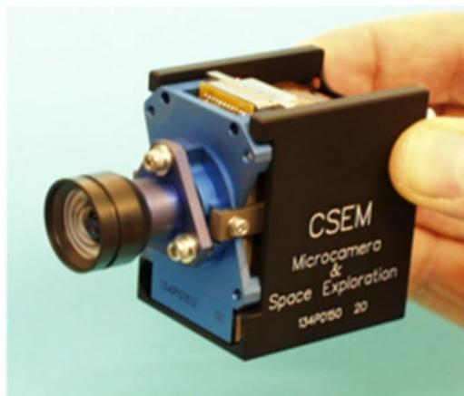
Mit einem Gewicht von je 100 Gramm bilden die Kameras einen Teil von CIVA (Comet nucleus Infrared and Visible Analyzer), einem von zehn Bordinstrumenten für Philaes Vor-Ort-Analyse des Kometen.
