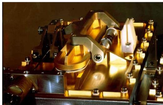
Mécanisme d'ouverture des portes de CSEM
