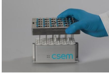
© CSEM – Kernstück des Geräts ist ein 24-kanaliges Laborutensil, entwickelt von CSEM.
