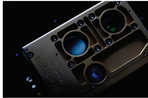
Le système de vision développé par le CSEM est composé d'un LIDAR permettant la saisie d'images 3D, ainsi que d'une caméra couleur 2D
