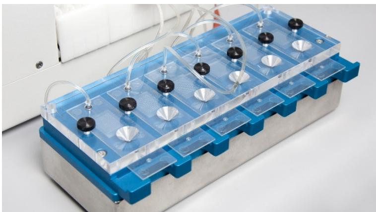
*Prototype du système fluide bio-analytique. Ce dispositif permet le traitement simultané de six biopuces pour l'analyse de six échantillons de patients.*
