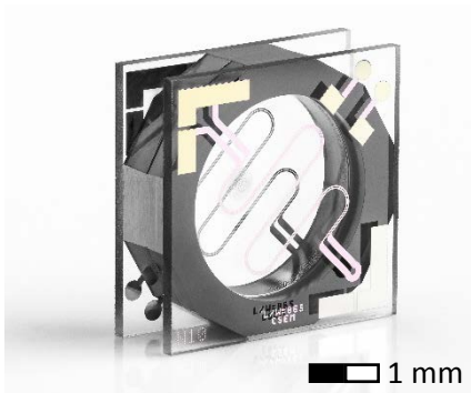
Cellule MEMS à vapeur atomique fabriquée au CSEM. Dimensions : 4 x 4 x 1.4 mm.
