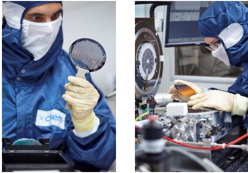
Développement de cellules MEMS à vapeur atomique dans les salles blanches du CSEM
